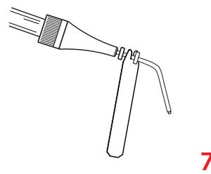
7 Enlever l'excès de matériau en faisant glisser un anneau de nettoyage en silicone à l'extérieur de l'extrémité de la pointe de l'aiguille.
