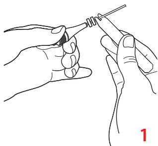
1 Placer un ou plusieurs anneaux de nettoyage en silicone sur la pointe de l'aiguille correspondante à l'aide de la clé.
