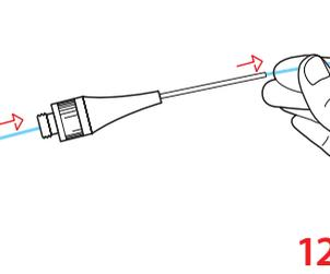
12 Nettoyez l'intérieur de la tête avec un fil dentaire rigide comme EMOFORM TrioFloss ou ProxySoft 3 in1 Floss. Pour plus de détails, voir l'étape numéro 1 du protocole de retraitement.
