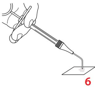
6 Préparer le matériau de réparation sur une plaque de verre et transférer la quantité requise de matériau dans le puits de remplissage. Introduire plusieurs fois la pointe (de l'aiguille) dans le matériau de réparation pour qu'il soit rempli.
